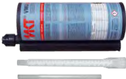
Kartuša VMU plus 825 Side-by-side kartuša, objem: 825ml s veľkou zmiešavacou dýzou VM-XL a s redukciou /predlžovacou rúrkou pre vrty od 12mm
